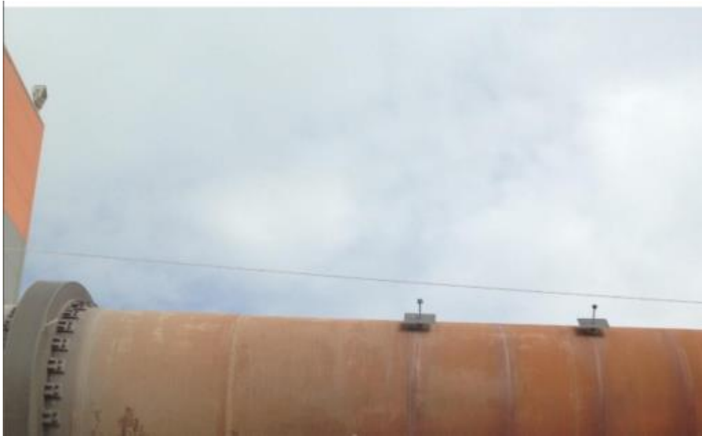
Рисунок 3 – Расположение датчиков температуры на кожух ТВП
