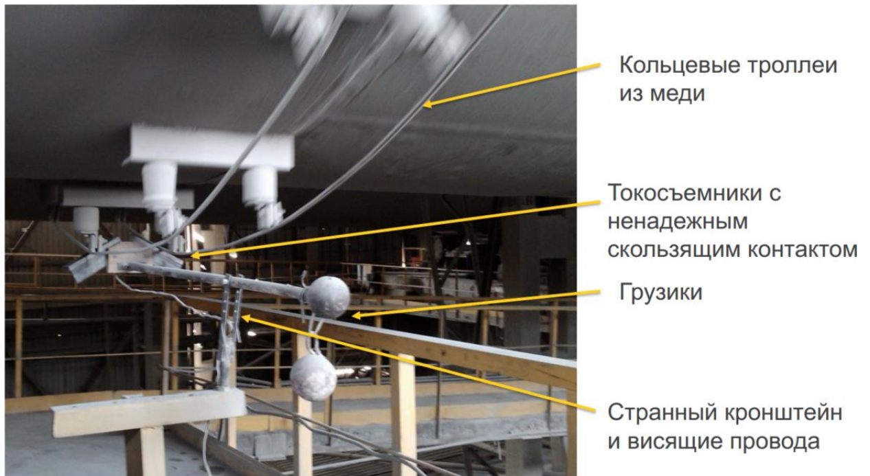
Рисунок 1 – Расположение датчика температуры на ТРП
